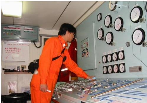
2006 年，筆者任貨櫃船大副時前往澳洲途中，在印度洋進行更換壓艙水作業：對老船來說是一項耗時和必須小心翼翼去做的事。
