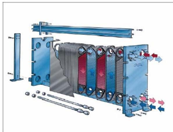
圖二 ALFA LAVAL 框架式板片熱交換器分解圖
